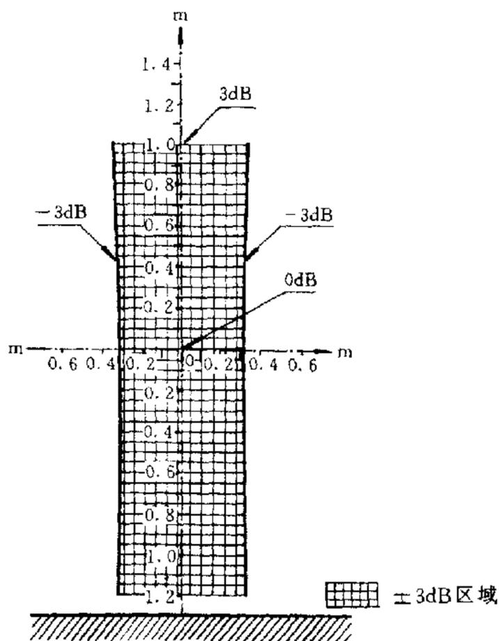
图 B8 矩形(1 m×2.6 m)感应线圈在中央垂直平面上产生的磁场的 3 dB 区域(垂直于线圈平面的分量)
