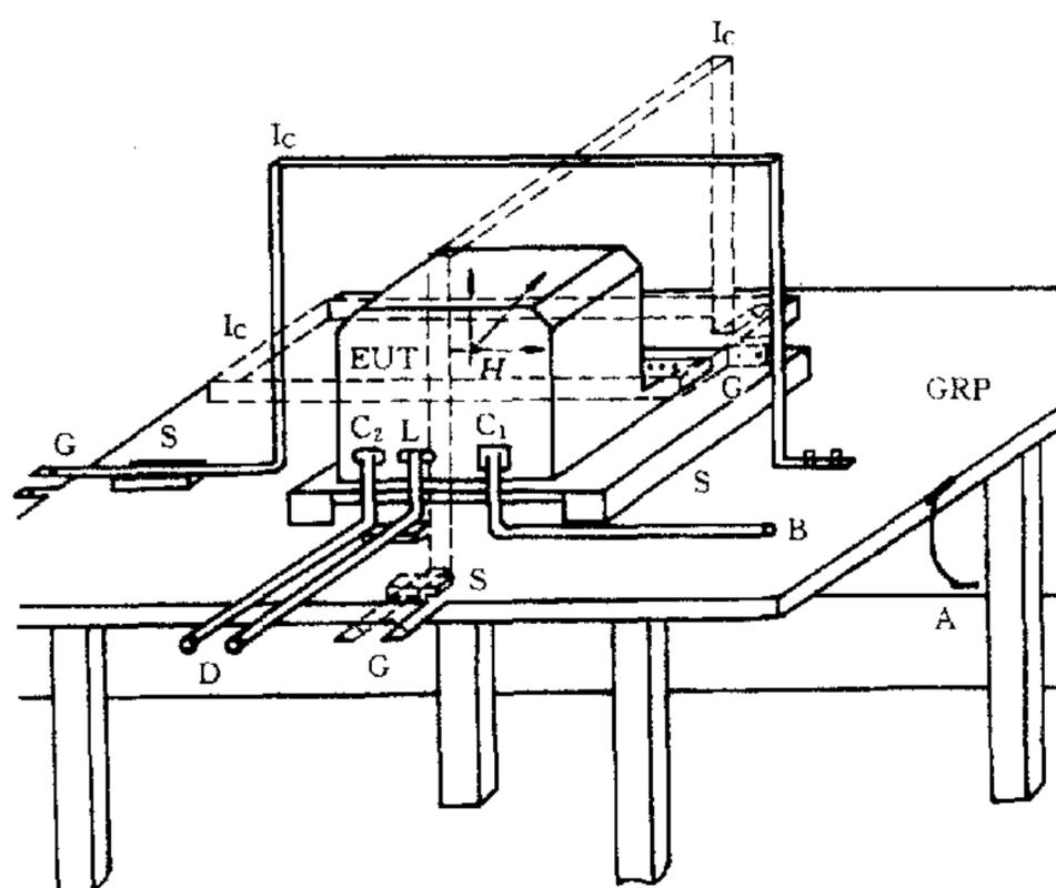
图4 台式设备的试验布置
