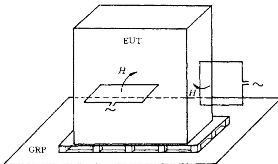
图 6 用邻近法探测磁场敏感性
