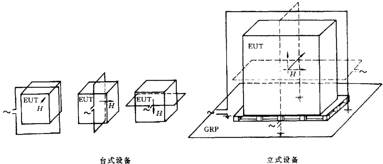
图 1 用浸入法施加试验磁场
